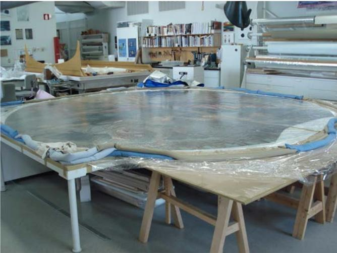
Figure 11. Pendant le doublage, table chauffante avec extensions.
