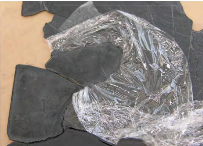
**Figure 9** : Détail d'un tesson en pâte époxy. On voit ici la pellicule plastique qui empêche la prise de l'époxy sur l'ardoise et permet un démoulage facile avec le corps principal du cadran. Photographie : André Bergeron, Centre de conservation du Québec.
